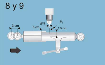
10. Mueva el vástago del pistón hacia arriba y hacia abajo para acelerar la expulsión del aceite.
